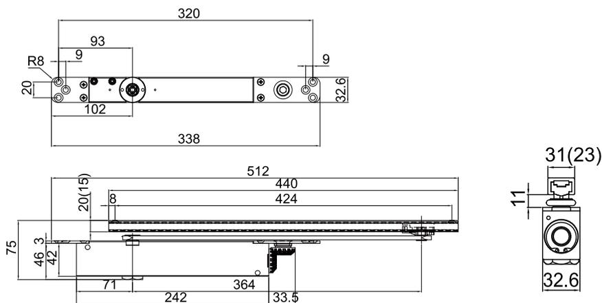
Nota: para portas de alumínio, aplicação em bitolas a partir de 42mm. Pré ajuste de fábrica Potência 3.
